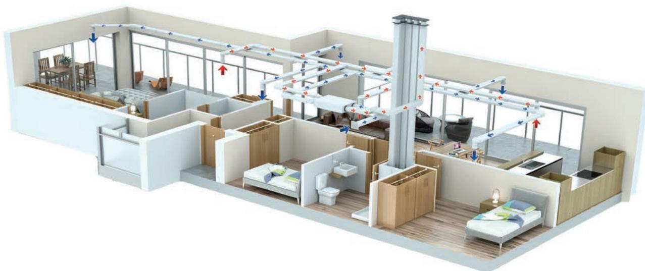
Ejemplo sistema de ventilación de doble flujo en una vivienda
